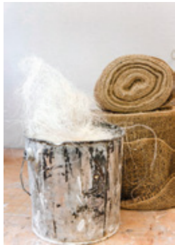
Die Jute dient der Armierung (o.). Ein Gipsprofil wird gegossen (r.), verstrichen (r. o.) und gezogen (r. u.).
